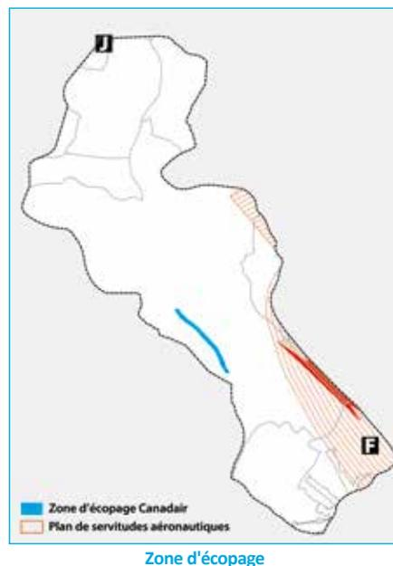
**Enjeux/sensibilités :** Les servitudes aéronautiques limitent la hauteur des obstacles tels que les pylônes d'une ligne électrique. Cette contrainte est déterminante dans la définition des fuseaux. Concernant la zone d'écopage, un passage du Rhône par la ligne électrique évitant le tronçon utilisé par les canadais sera recherché.
